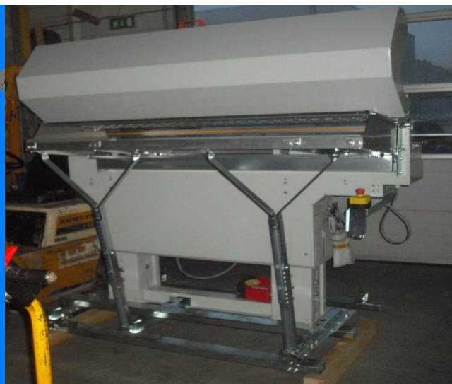
HATEC AM 90 L(*)L ("LINKS") mit Verschiebeeinheit VE500-L
